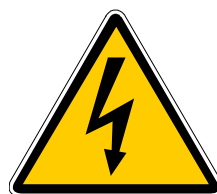
tensione elettrica pericolosa
